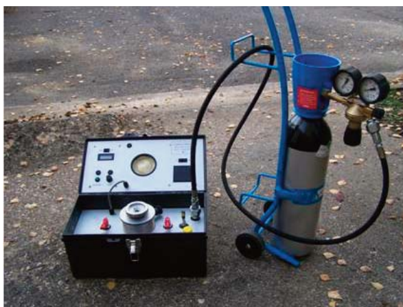
La chambre à pression mesure le potentiel hydrique de la plante
